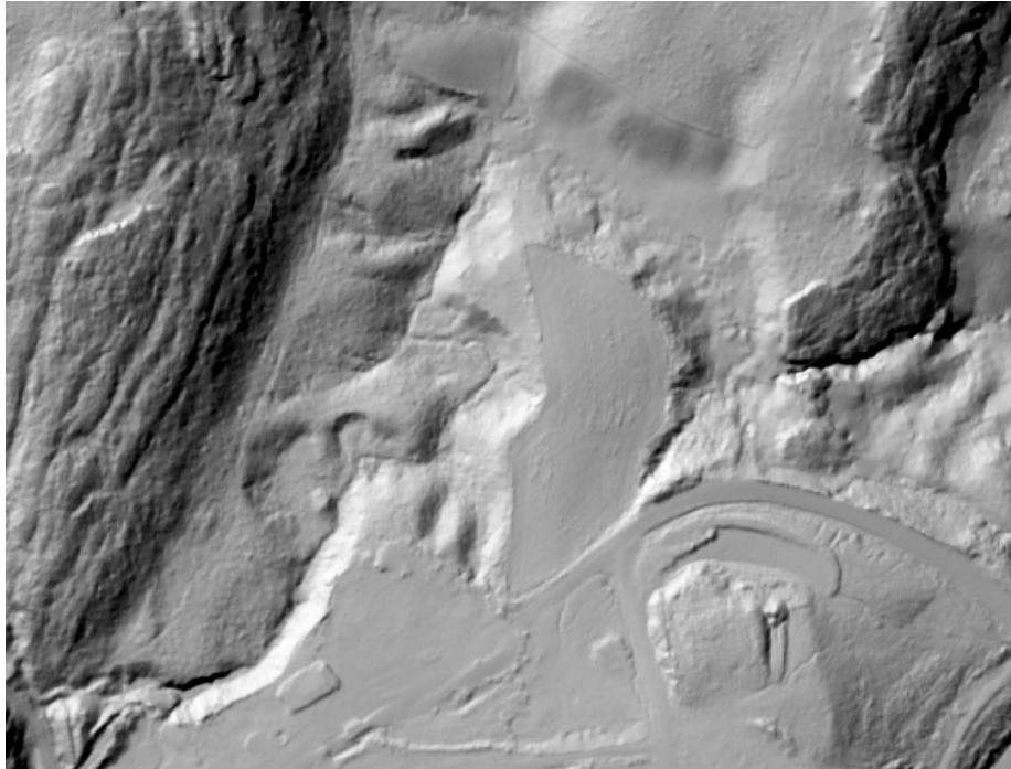
Figur 12. Terrengmodell av bekkeløpet til Stammyrvassbekken.
