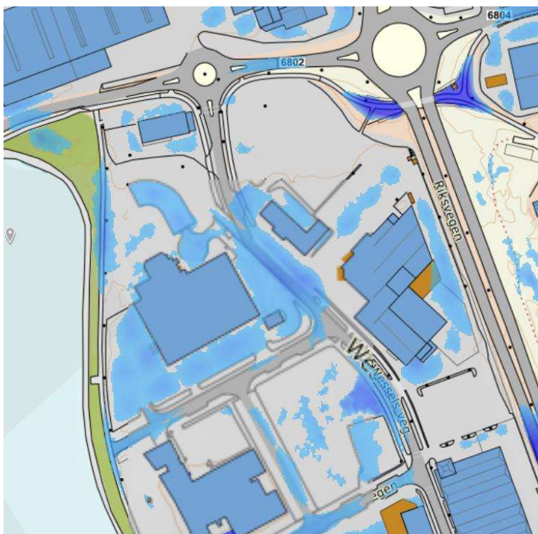
FIGUR 16 UTKLIPP FRA SCALGO LIVE VED SIMULERT 100-ÅRS HENDELSE. ALL OPPSTUVING PÅ TERRENG MARKERT I BLÅTT
