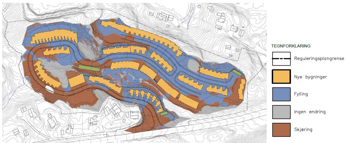
Figur 37: Terrengendringer med fylling og skjæringer gitt av nytt planlagt terreng.
