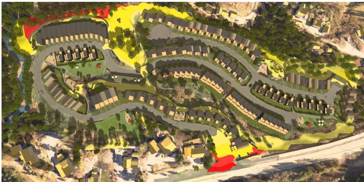
Figur 45: Støysoner fra vegtrafikk er drapert på terrengmodellen og viser hvordan bebyggelsen og andre støyskjermer danner stille soner i uteareal (1,5 m beregningshøyde).
