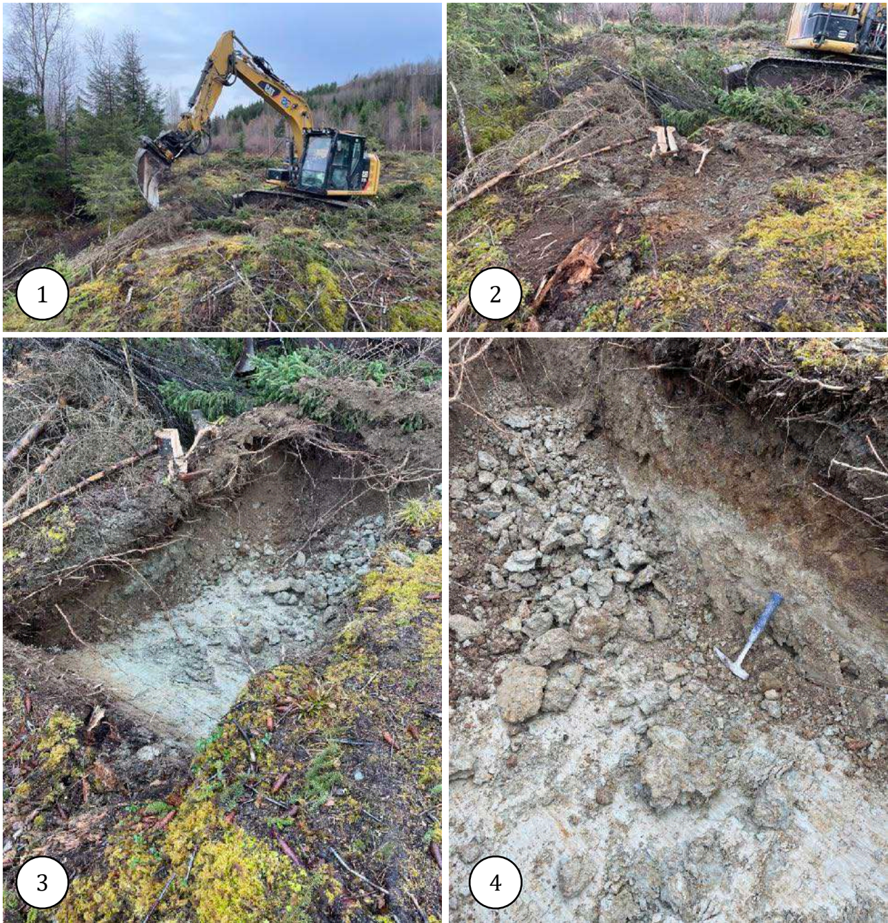
Figur 10. Fire bilder som viser prøvegravingen på lokasjon 5, se teksten og Figur 11 for dyp og beskrivelse i teksten
