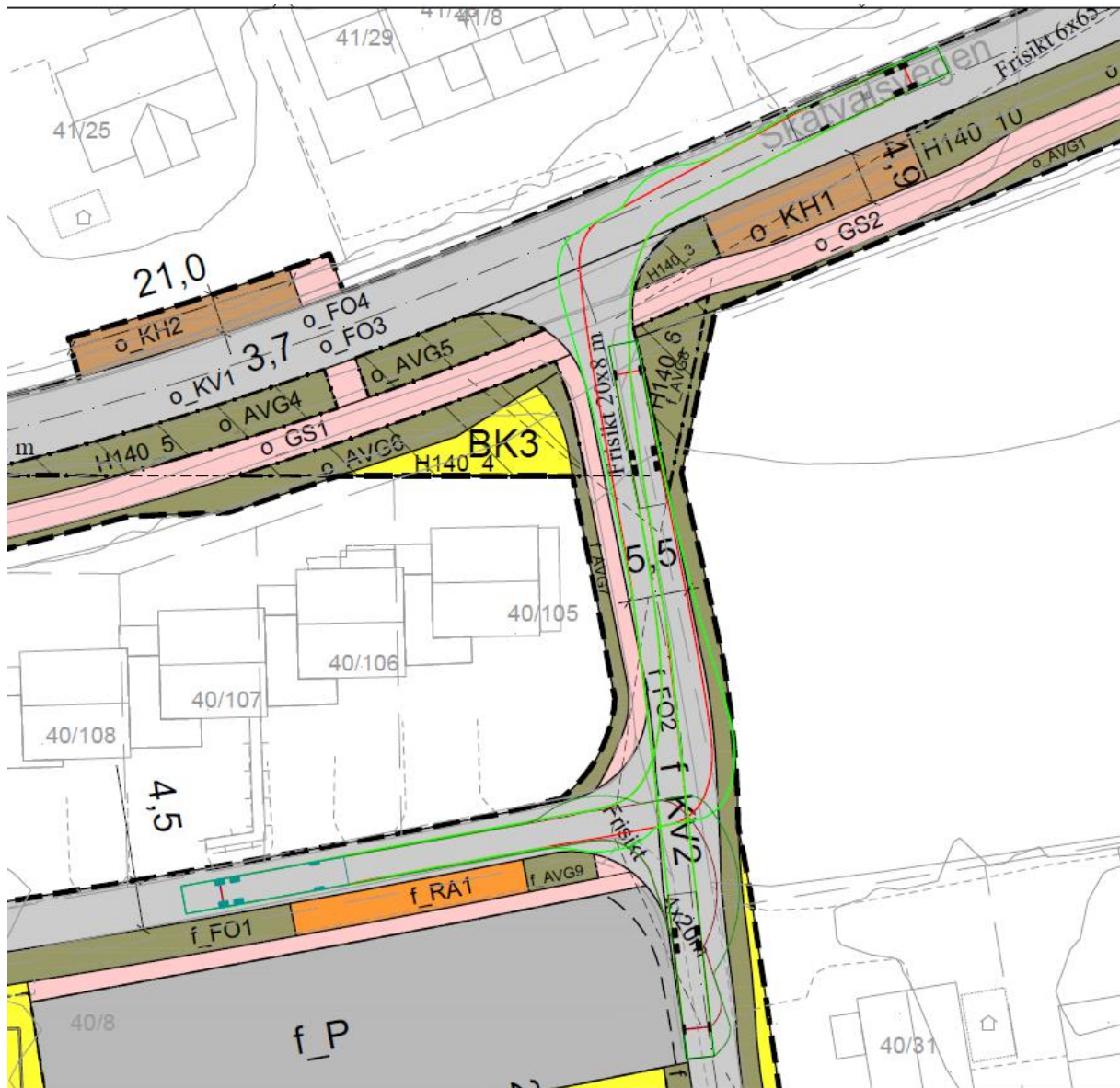
Figur 5.18: Sporingskurver for buss, 15 meter.
