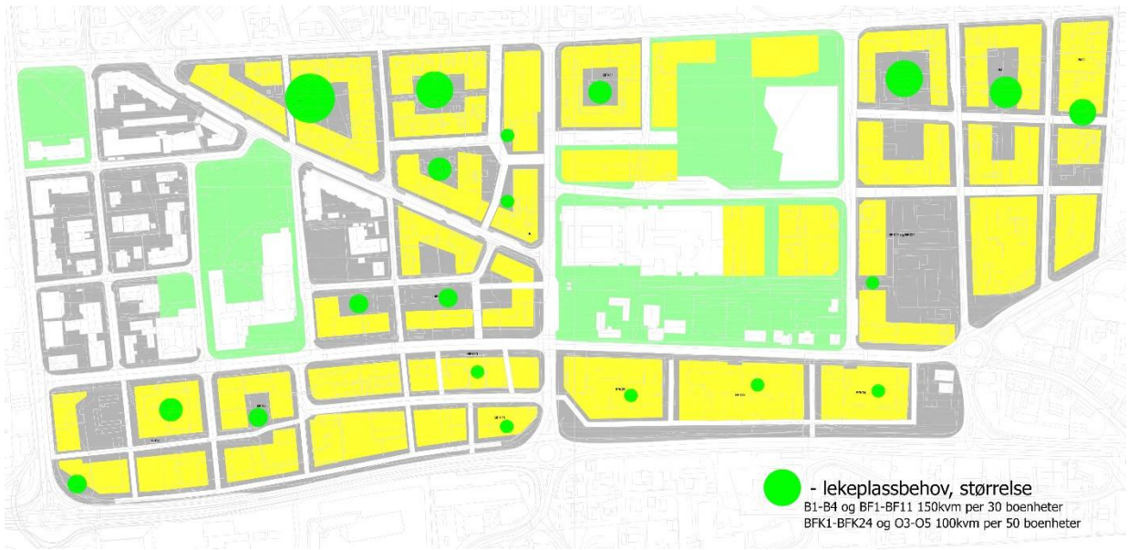
Figur: Krav til størrelse lekearealer, størrelse på grønn sirkel tilsvarer faktisk arealbehov for lekeplass.
